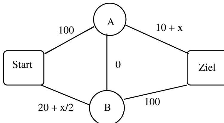
100 Autos wollen von Start nach Ziel fahren. Die Fahrzeiten sind wie angegeben. Auf der Straße von Start nach B ist die Fahrzeit  $20 + x/2$  Minuten, wenn sie von  $x$  Autos befahren wird. Nehmen Sie zunächst an, dass die Straße zwischen A und B NICHT existiert.
