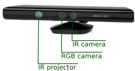
IR projector + IR camera: 3D depth sensor
